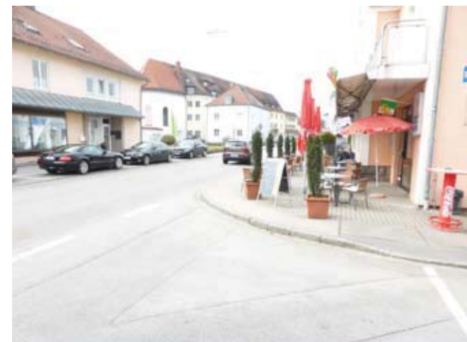
Abb. 2.38 Passauer Straße: Gehwegeinengung durch Pflanztröge und Außengastronomie
